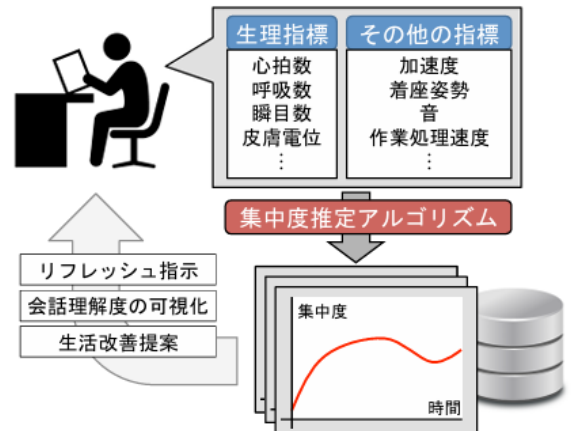
図1 濱谷らの提案システムの構成図 ([5] より引用)
