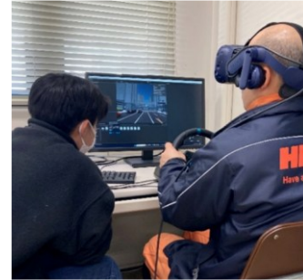
図 1 消防士向け VR 緊急走行シミュレータ[4-6]
