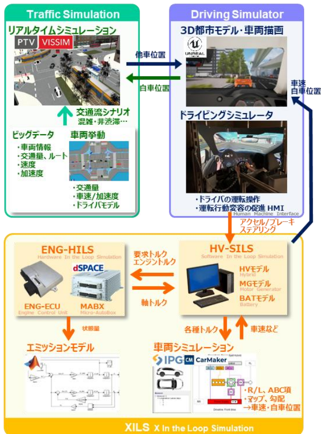
図6 デジタルツイン評価環境のシステム構成図
