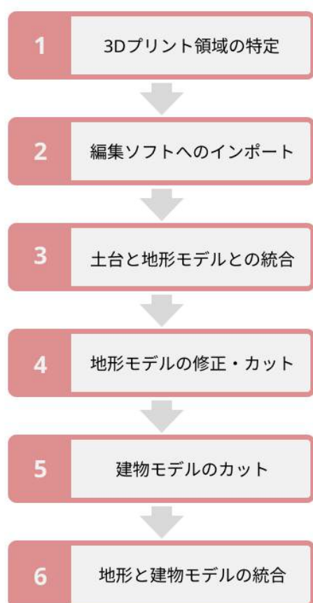
図4 都市データを印刷用データへ変換する処理の流れ。
